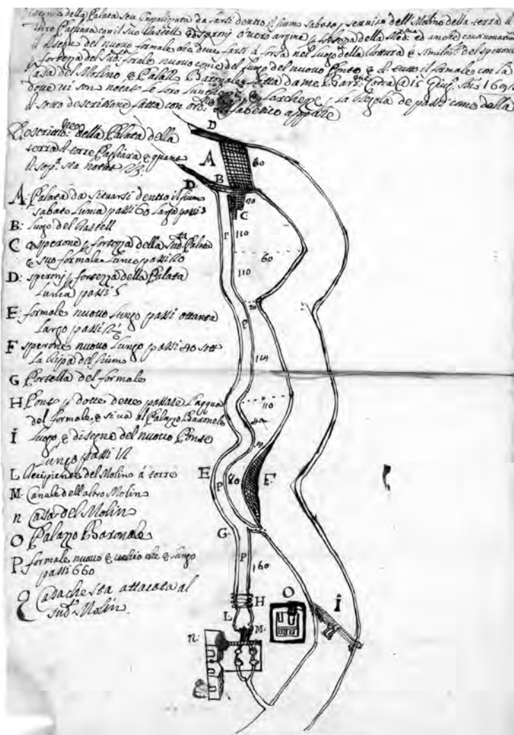
Disegno della palizzata da farsi nel fiume Sabato e del nuovo formale (cioè il canale) del mulino di "Pagliara", con "casa del Molino", nel comune di San Nicola Manfredi, Benevento.
